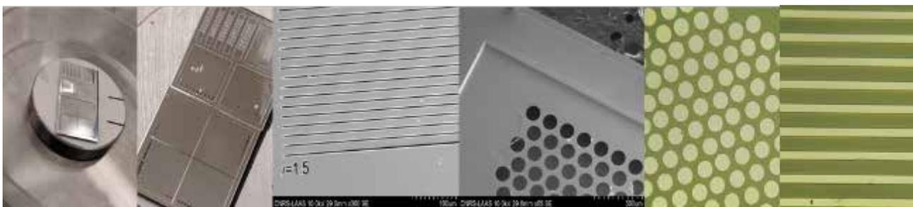
Contrairement au shadow mask basse résolution  $> 10 \mu\text{m}$ , ces shadow mask sont fabriqués en 2 étapes de dépôts électrolytiques de Ni. La première pour réaliser une membrane de Ni de quelques microns qui permet d'obtenir une résolution jusqu'à  $1.5 \mu\text{m}$  et une seconde étape qui permet de réaliser un cadre de Ni de  $40 \mu\text{m}$  d'épaisseur afin d'obtenir une rigidité nécessaire pour sa manipulation.
