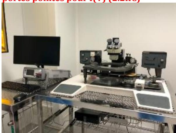
La caractérisation I(V) présente sur la zone permet de vérifier l'état de vos composants électroniques sans devoir les sortir de l'environnement propre. Utile avant de réaliser des mesures plus complètes hors salle blanche. Le passage en trois pointes pour mesurer l'effet transistor est prévu.
