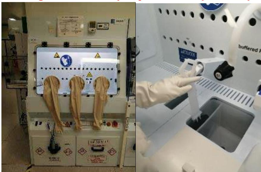
La transformation du poste de chimie pour acide fluorhydrique en boîte à gants a été finalisée, ce poste permet désormais un traitement sécurisé des plaquettes (traitement et rinçage en bacs verticaux, avec suivi résistivométrique du rinçage). La protection de l'opérateur est nettement renforcée, tout en allégeant le port des EPI. Ce système fermé se rapproche des systèmes clos légalement exigible pour les personnels non permanents manipulant l'acide fluorhydrique.
