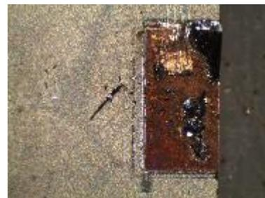
Cuivre oxydé lors de la thermocompression
