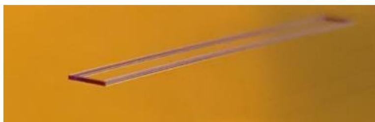
Figure 2 : WBR2100 pour la fabrication d'un shadow mask
