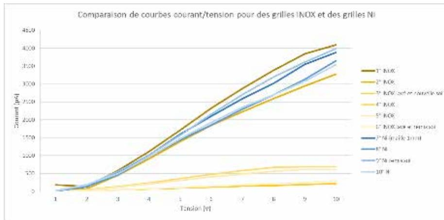
Les grilles étaient jusque-là réalisées en inox avec une reproductibilité de conduction électrique assez dispersée (courbes en jaune). En les réalisant en Nickel, nous avons obtenu des grilles beaucoup plus reproductibles en dimension ce qui se traduit par une dispersion de conduction électrique beaucoup plus faible (courbes en bleu). L'utilisation du Ni permet également de tester différentes géométries de grille comme nouveau paramètre.
