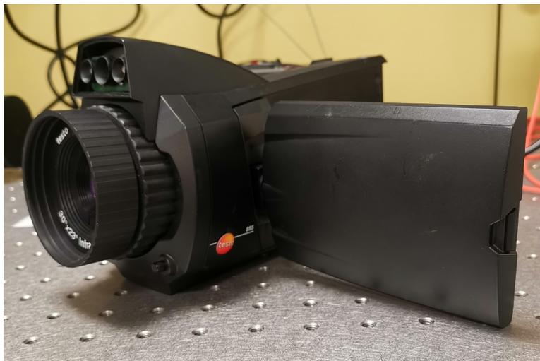
FIGURE III.2 – Caméra thermique infrarouge testo modèle 885.
