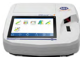
FIGURE 1.6 – Système photométrique Nanocolor de la société Marcherey-Nagel [6].
